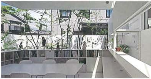
「アトリエ・ビスクロール」(2009) 近隣の緑や全面道路を外部空間とみても、重力から解放された腰壁＝浮遊する帯で敷地全体を取り巻いてみる。互いにバランスしながら二重、三重と積層していく「ハコ」。アトリエと住宅という二つの機能は3重に直交する帯によってワンルームの空間となる。構造要素は3つ。すなわち浮遊する帯(＝サンドイッチ鋼板)、軽量の屋根架構(＝平行弦トラス)、棚を利用した耐力壁(＝鋼板壁)だ。3つの要素は互いに分離しながら全体系へと統合され、建築空間の境界の曖昧さや領域のなさが共振している。(左:©前田圭介)
